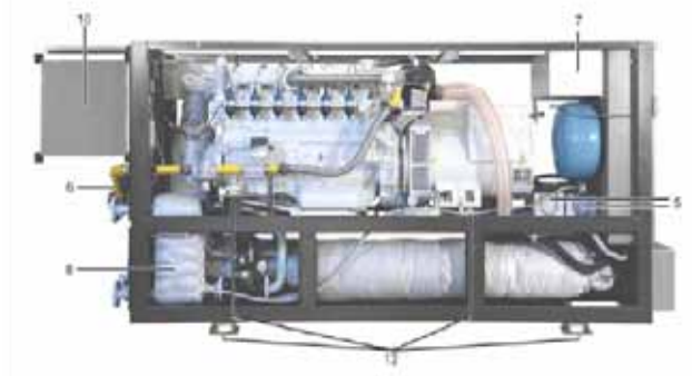
Resim 4. Paket tipi kojenerasyon sistemi yapı parçaları ve yapı grupları, soldan görünüş. 1 Gaz motoru, 2 Senkron jeneratör, 3 Egzost temizleme sistemi, 4 Egzost gazı ön susturucu, 5 Starter sistemi, 6 Gaz kontrol hattı, 7 Yağ göstergeli yağlama sistemi, 8 Dahili soğutma devresi (plakalı eşanjör), 9 Ses koruma kabini, 10 Kabinli hava tahliye fanı, 11 Kumanda panosu, 12 Elastik yataklama - Titreşim alıcısı altlık
