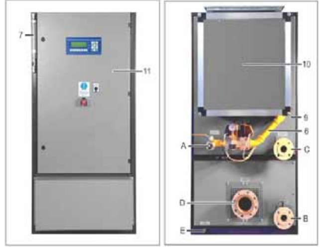
Resim 7. Paket tipi kojenerasyon sistemi yapı parçaları ve yapı grupları – önden ve arkadan görünüşler. 1 Gaz motoru, 2 Senkron jeneratör, 3 Egzost temizleme sistemi, 4 Egzost gazı ön susturucu, 5 Starter sistemi, 6 Gaz kontrol hattı, 7 Yağ göstergeli yağlama sistemi, 8 Dahili soğutma devresi (plakalı eşanjör), 9 Ses koruma kabini, 10 Kabinli hava tahliye fanı, 11 Kumanda panosu, 12 Elastik yataklama - Titreşim alıcısı altlık, A Gaz bağlantısı, B Isıtma suyu girişi (Isıtma sistemi dönüşü), C Isıtma suyu çıkışı (Isıtma sistemi gidişi), D Egzost gazı bağlantısı E Kondens tahliye ağız
