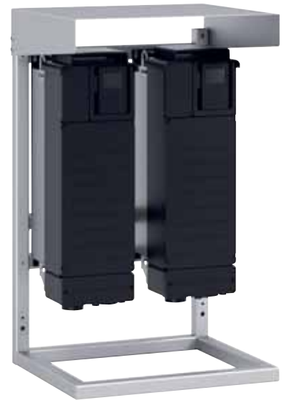
Ausgelagerte Frequenzumformer in einem schlanken Gehäuse ermöglichen ein kompakteres Wärmepumpengehäuse und erleichtern dadurch die Einbringung.
