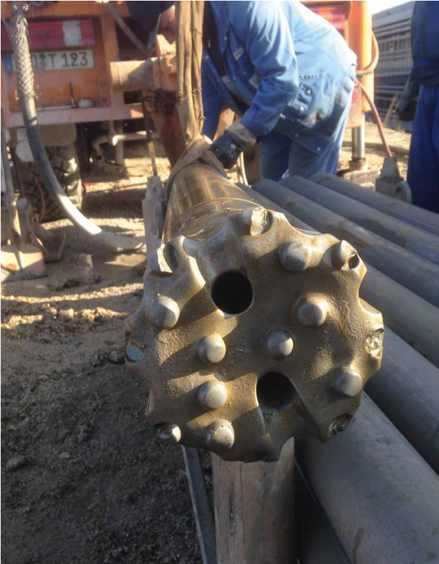
Bir sonda deliği oluşturmak için matkap ucu. (Foto: Erdwärme plus)
